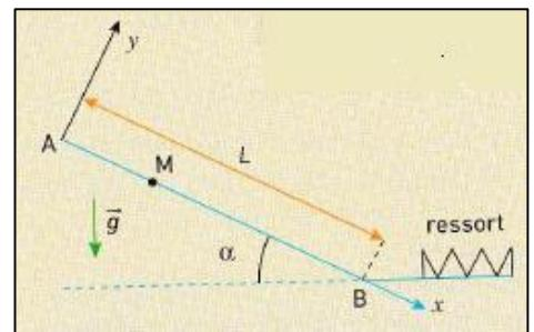
Le mobile part du point A d'abscisse  $x_A = 0$  avec une vitesse initiale nulle,  $v_A = 0$ , et glisse jusqu'au point B d'abscisse  $x_B = L$  où on note  $v_B$  sa vitesse.
